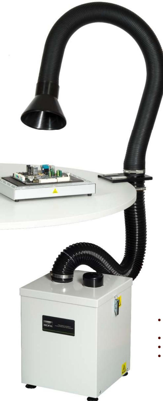
V300E (старое название SYSTEM 300E или SYS300E) - бюджетный дымоуловитель на 1-2 рабочих места для небольшого паяльного оборудования, работает с дымоприемниками диаметром 75мм или с вытяжной кабиной FC-600. Увеличенный диаметр воздуховодов обеспечивает максимальную производительность, что особенно важно для работы с рассеянными источниками дыма, какими, например, являются ремонтные термовоздушные и ИК-станции, тигели, термостолы, небольшие ковекционные печи и т.п.
